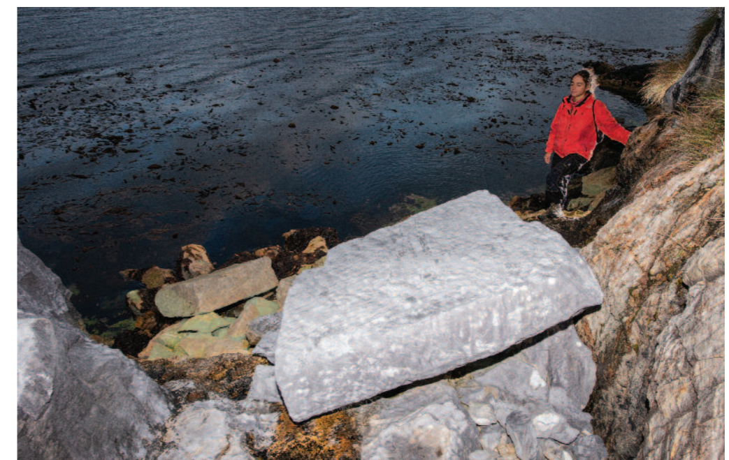
◀ Reste de l'exploitation des marbres de Diego De Almagro d'une très grande pureté : 98,3 % de carbonate de calcium et 0,7 % de carbonate de magnésium.
